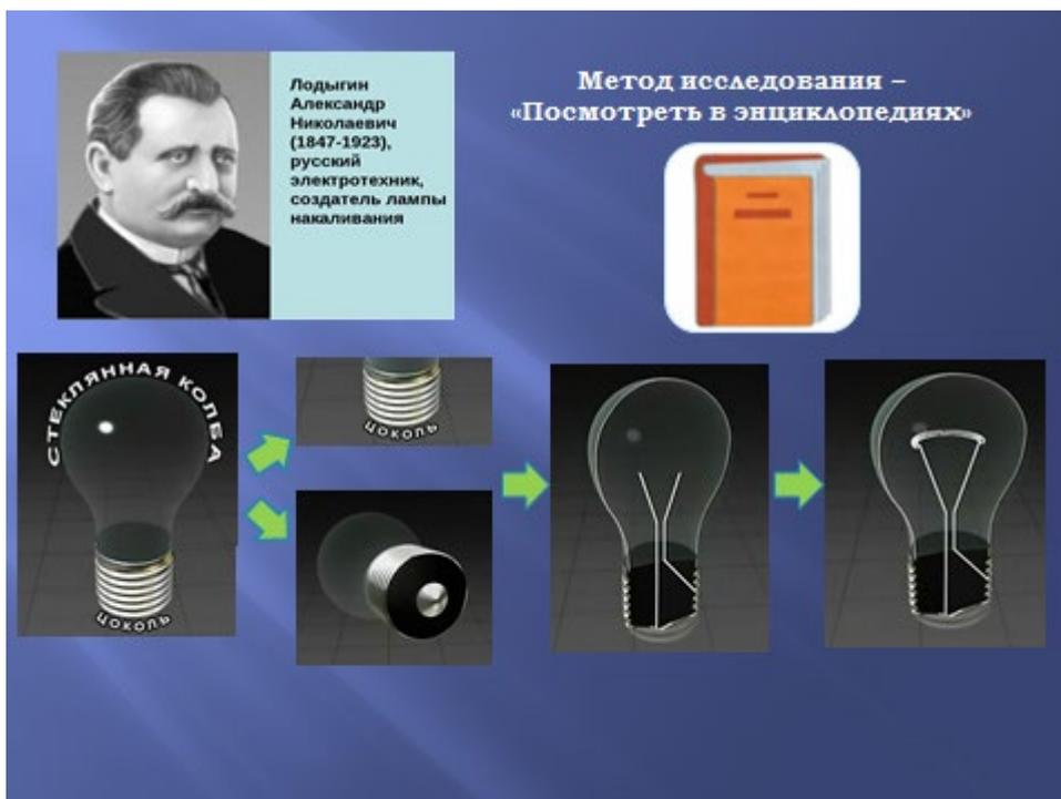
Рис. 4. Конструкция электрической лампочки
